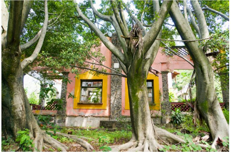
Figura 33. La Quinta Palmira en Cuernavaca en estado ruinoso. Se observa el recubrimiento de piedra de río en columnas en su fachada sur. Fuente: fotografía de la autora.
